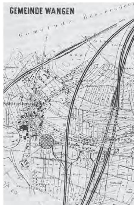
Drei Varianten der Autobahn zwischen Wangen und Brüttsellen aus dem Jahr 1965. Zwei davon hätten in einem Tunnel unter der Radaranlage hindurch geführt.
